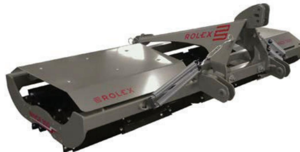
I rulli a lame con un diametro di 380 mm sono montati sull'attacco a tre punti anteriore. È composto da sei segmenti su cui sono montati lame da taglio in acciaio al boro 30MnB5 da 8 mm. Il suo compito principale è quello di macinare i raccolti e le stoppie dopo il mais.
