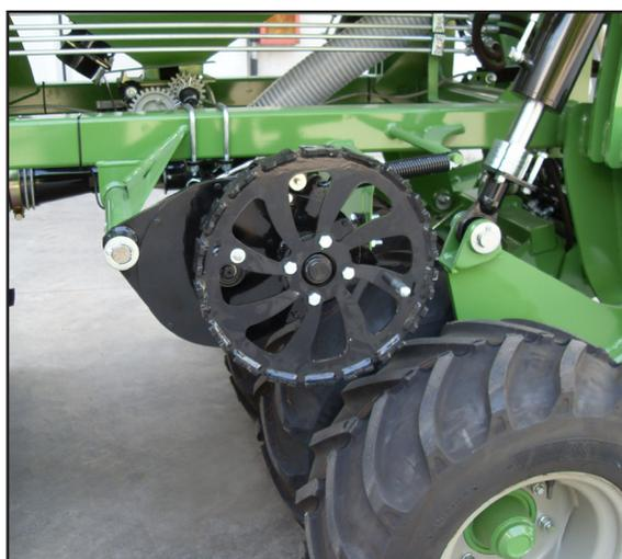
Ruota di trasmissione
