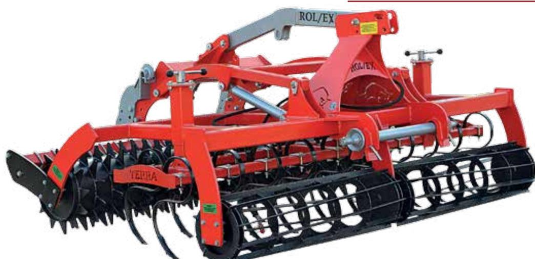
Due file di denti, hydropack su due attuatori, rullo tubolare posteriore, a corda oppure a corda dentato 500mm, con esclusione di rulli tandem, rullo a corda anteriore, verniciatura in polvere.
