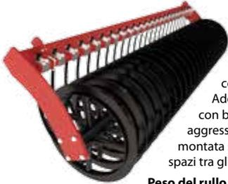
Il rullo del diametro 500mm delle caratteristiche come nel caso di rullo a cappello, costruito dalle sezioni di anelli in forma di 'T'. Addensa la terra in strisce. È ideale per i terreni con blocchi prendendo in considerazione il profilo aggressivo dei suoi anelli. Su questo rullo è anche montata sezione di lunghi raschietti che sgombera gli spazi tra gli anelli.
