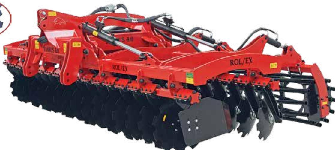
Due file di dischi Ø560 mm, ammortizzatori in gomma 50 mm x 190 mm, rullo tubolare o rullo a corda Ø500 mm, schermi galleggianti, aumentato spazio tra disco e telaio di 12 cm, grazie ad un piede allungato di disco, distanza tra file di dischi 100 cm, aumentato spazio di rullo per coltivazione di 20 cm, dischi montati sulla barra di profilo 90mm/90mm/6mm, verniciatura in polvere.
